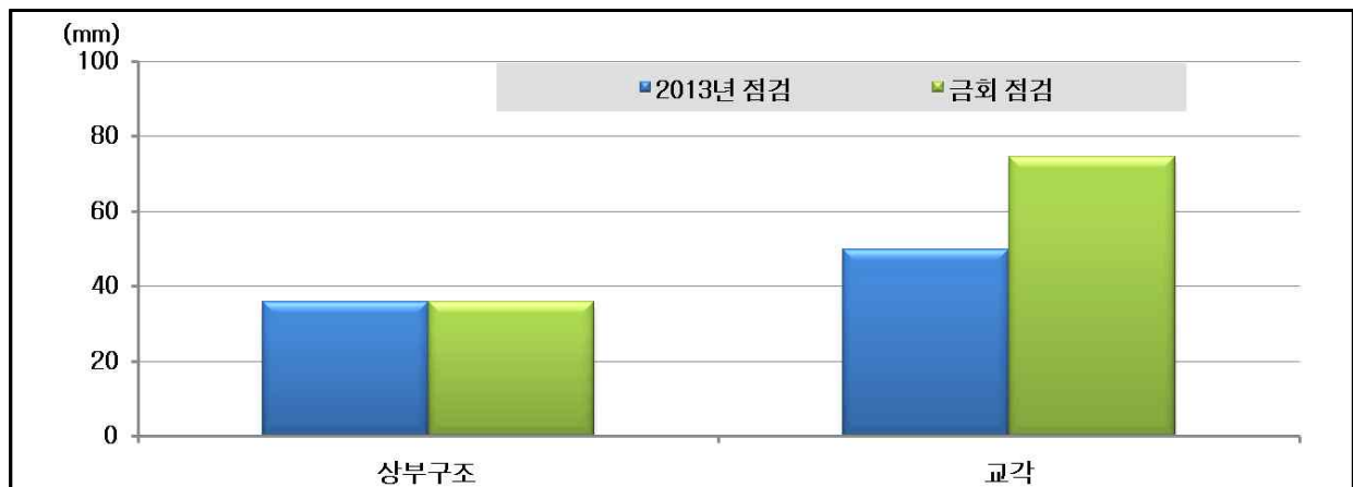
【그림 4.4】 부재별 탄산화깊이에 의한 콘크리트 잔여피복두께 비교
